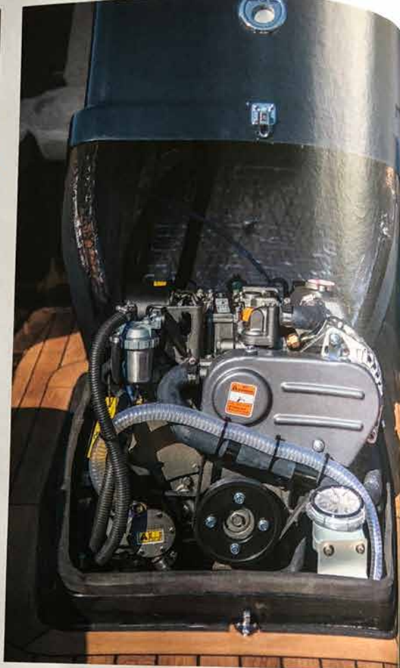
▲ Standardmotorn från Yanmar är på 21 hästkrafter och ger gott om kraft. Toppfarten är strax över sju knop, en vettig marschfart ligger närmare fem.
