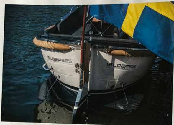
▲ Räddningsstegen består av ett enda handtag i aktern, på babordssidan. För en skadad, nedkyld person blir det mycket svårt att ta sig upp. Farligt!
