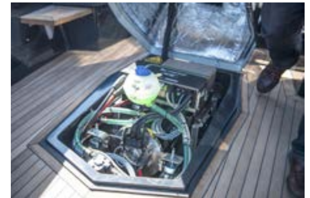
▲ Elmotorn från holländska Belmarine leverar 20 kW och ryms under motorkåpan. Kylvattnet kommer från sjön.
