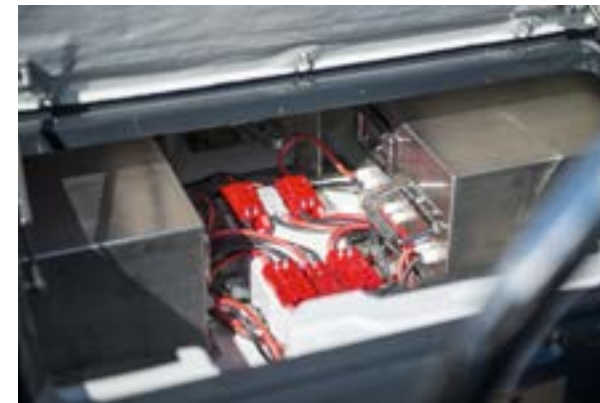
▲ De två svetsade, vattenskyddade aluminiumlådorna rymmer vardera 10 kWh batterier. Totalt 20 kilowattimmar och 160 kilo.
